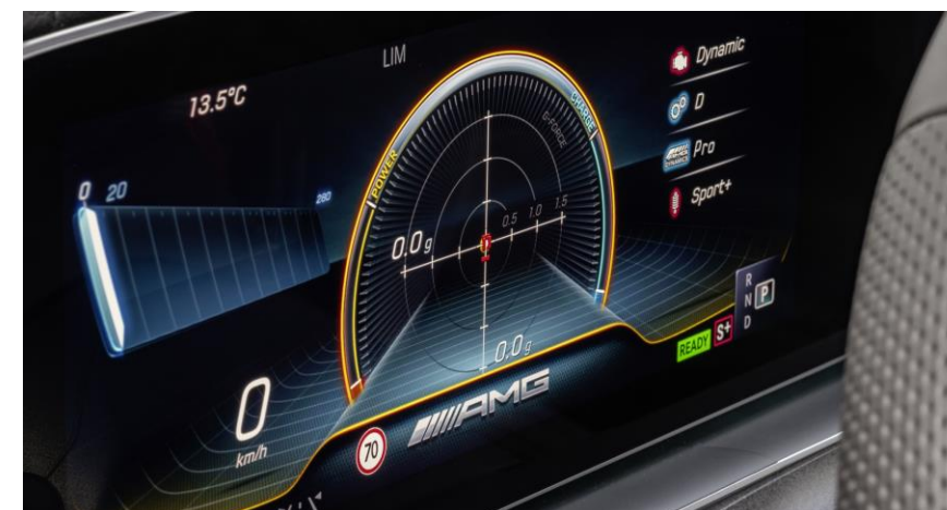
Dos pantallas de 12,3" para cuadro de instrumentos y sistema de infoentretenimiento MBUX
