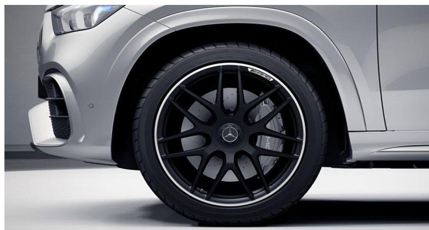
Llantas forjadas AMG de 22" en diseño de radios cruzados , color negro mate y pestaña exterior pulida a alto brillo, delante: 285/40 R 22, detrás: 325/35 R 22
