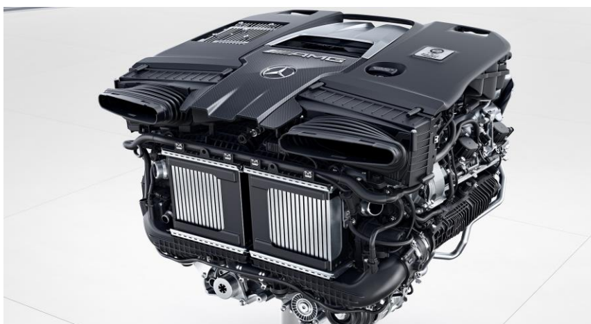
Tecnología EQ Boost: capaz de entregar hasta 22CV y 250Nm mediante el uso de alternador arrancador integrado de 48V
