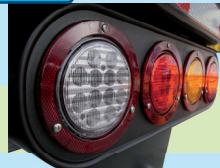
Nuevas señaléticas LED. Focos con borde reflectante y sistema apernado antirrobo
