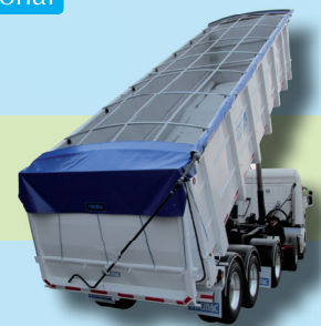
NUEVO Sistema de Auto encarre ROLL TARP
