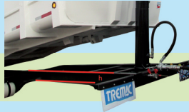
Menor altura VIGA Centro de gravedad mas bajo del mercado
