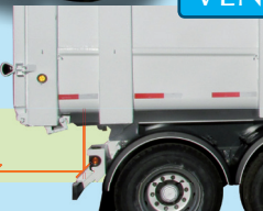
Mayor distancia entre pivoteo y puerta. Mejora y aleja descarga de material
